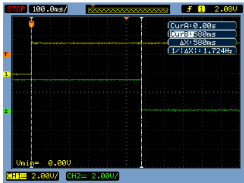
Figure: GPIO: 测量 boot rom 用的时间
